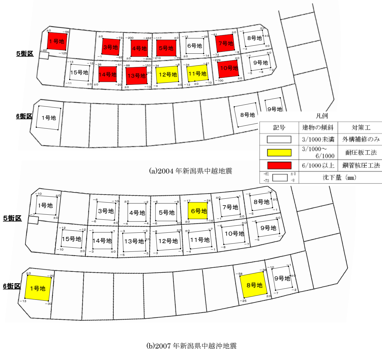
図-5 新潟県中越地震と新潟県中越沖地震建物の沈下・傾斜および対策の比較
