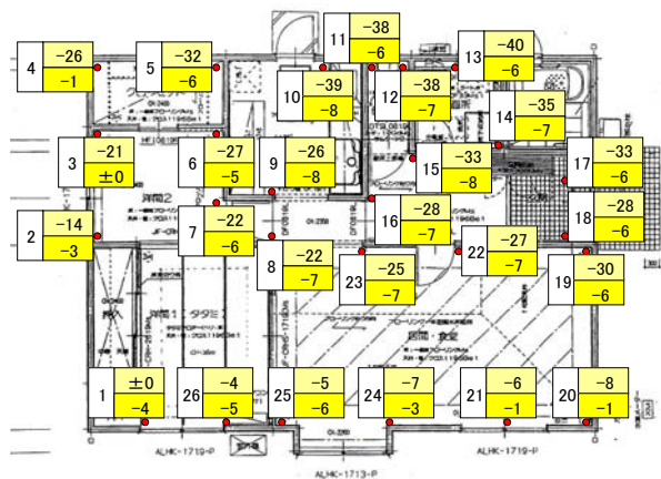
(b) 耐圧板対策箇所の不同沈下量
