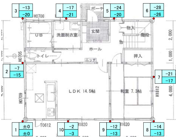
(c) 外構補修対策箇所の不同沈下量
