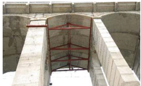
写真-11 アーチクラウン継ぎ目部の破壊
