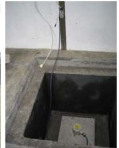
図-4 PDG001アンダラス大観測点の強震計設置状況
