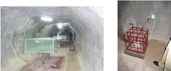
図-7 BKT001プキティンギ市の旧日本軍要塞内観測点の強震計設置状況
