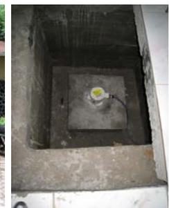
図-5 PDG002クランジ郡庁舎観測点の強震計設置状況
