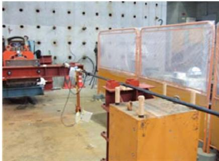
写真-3 光ケーブル引張試験
