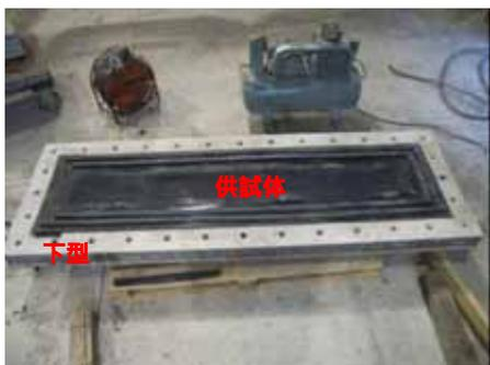
(b) 下枠への供試体の設置
