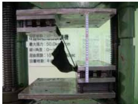
(c) 二次耐圧部破断時
