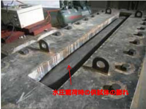
写真-9 止水試験（水圧載荷時）の状況
