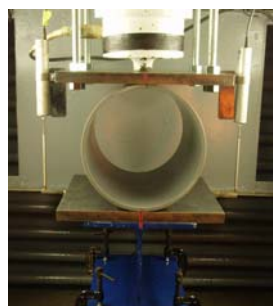
写真-5.1 偏平試験の状況
