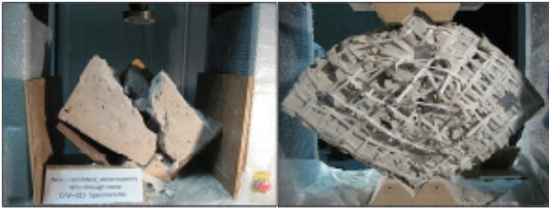
図-5 载荷試験後の供試体（左：無補強供試体，右：PP-band補強供試体）
