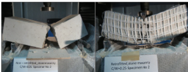
図-9 試験後の供試体（左：無補強供試体，右：PP-band補強供試体）
