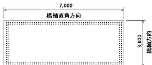
圖一 3 橋脚断面
