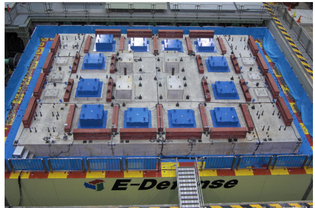
図-9 せん断力加振試験体設置状況
