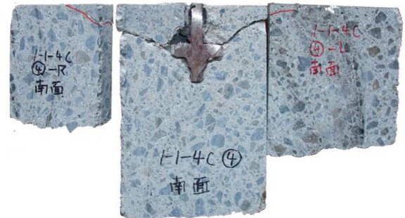
図-6 内部ひび割れ状況 (試験体 I-1-4)
