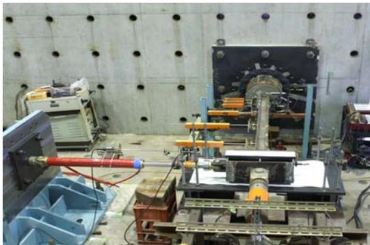
写真-1 古レール柱の交番載荷試験
