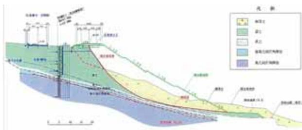
図-14 検討対象谷埋め盛土の地質構造と崩壊形態<sup>12)</sup>
