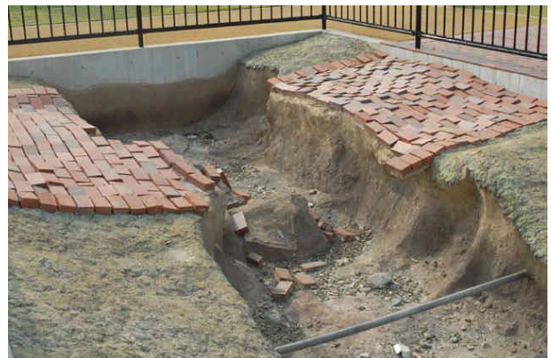
図-6 完成した原寸大地割れ模型
