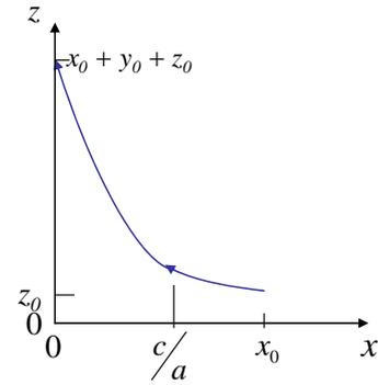
図-3(b) 防災数理基本モデルの x-z 位相平面解軌道
