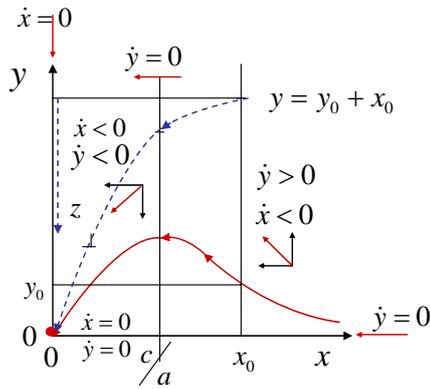
図-3(a) 防災数理基本モデルの x-y 位相平面解軌道
