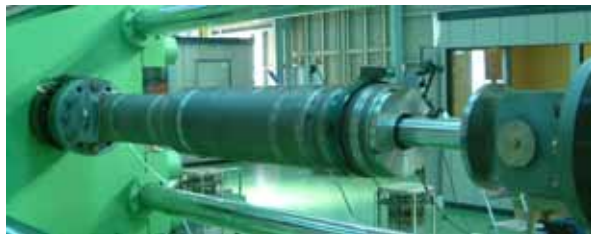
写真-1 粘性ダンパー性能検証実験の載荷状況
