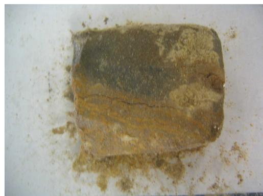
写真 5 スレーキング試験状況(布又試料)
