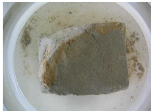
写真 6 スレーキング試験状況(横渡試料)
