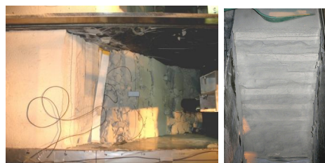
図-11 流れ盤斜面模型の崩壊状況（左：実験直後の崩壊の様子，右：崩土除去後）
