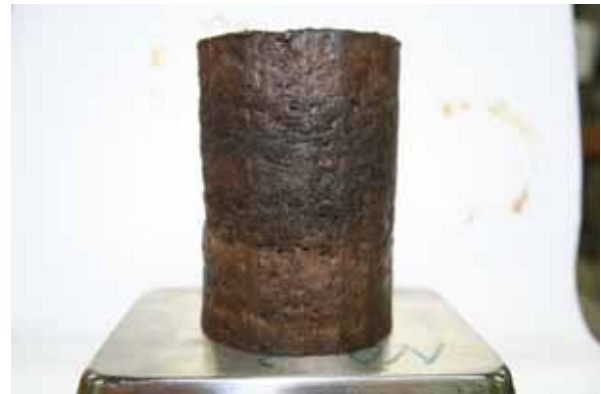
(a) 動的変形特性試験後の供試体
