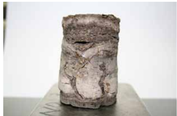
(b) 動的変形特性試験後の炉乾燥供試体
