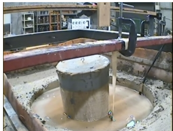
写真1 無対策のケースの浮上り状況
