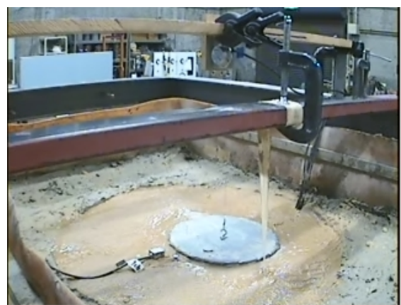
写真2 過圧密比が 1.80 で対策したケースの浮上り状況
