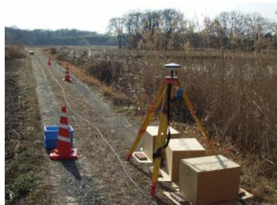
図-3: 地震計の設置状況 (No.3 荒川河川敷)。段ボール箱は風よけで、それぞれの箱に 1 成分ずつ地震計がおかれている。三脚は GPS のアンテナと端末。
