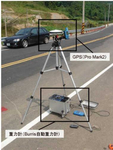
図-7 重力観測に用いた測定機材
