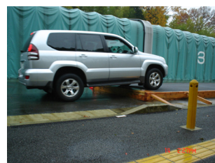
写真-2 オフロード車 乗上げ走行
