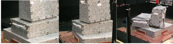
(a)震度 6 弱加振後 (b)震度 6 強加振後 (c)震度 7 加振後 図-7 無補強墓石(洋型)の実験結果
