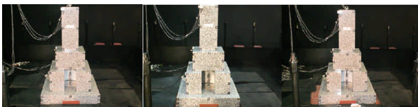
(a)震度 6 弱加振後 (b)震度 6 強加振後 (c)震度 7 加振後 図-10 長ボルト工法の実験結果
