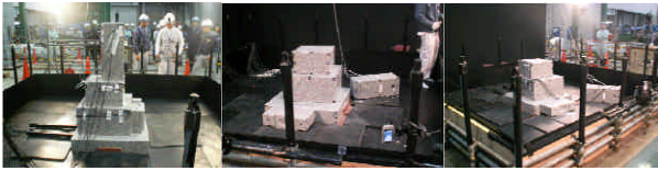
(a)震度 6 弱加振後 (b)震度 6 強加振後 (c)震度 7 加振後 図-6 無補強墓石(和型)の実験結果
