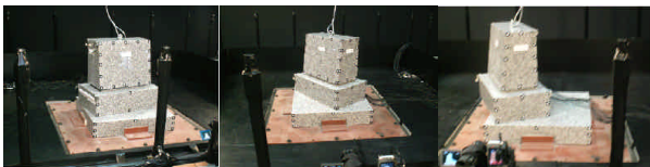
(a)震度 6 弱加振後 (b)震度 6 強加振後 (c)震度 7 加振後 図-9 ダボ工法(洋型)の実験結果
