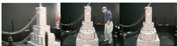
(a)震度 6 弱加振後 (b)震度 6 強加振後 (c)震度 7 加振後 図-11 免震金具工法の実験結果
