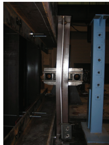
図-9 ウェブおよび垂直補剛材の変形（ \beta 形式）
