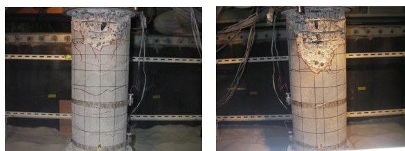
(a) 西側(正方向) (b) 東側(負方向) 写真-4 試験体の損傷状況(気中載荷)
