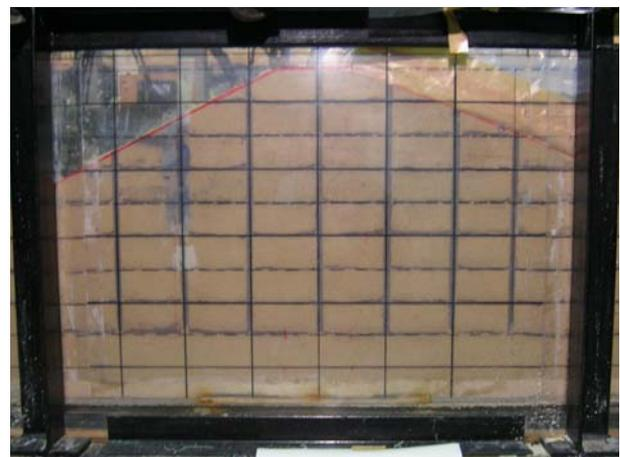
図-12 加振後の地盤状況（表面遮水型, Dr = 70 %）
