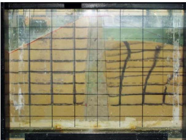
図-11 加振後の地盤状況（中央遮水型, Dr = 20 %）
