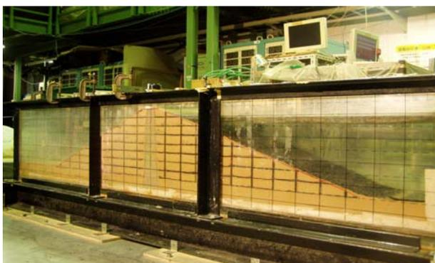
図-3 中央遮水型アースダムの写真（手前:上流側）
