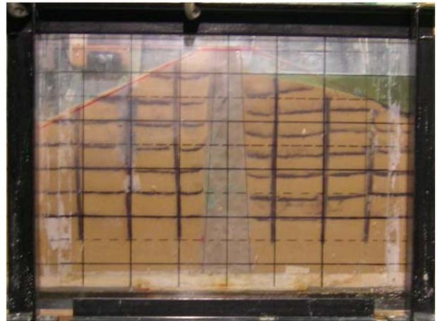
図-10 加振後の地盤状況（中央遮水型, Dr = 50 %）
