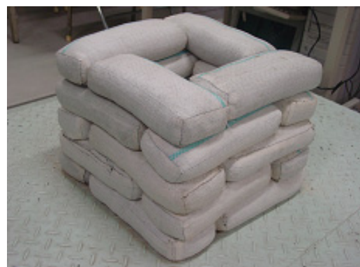
写真-3 土のう型ドレーン材 (5段)
