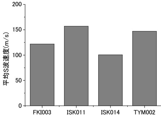
図-10 三角州・海岸低地、後背湿地に分類された観測点における表層20mの平均S波速度
