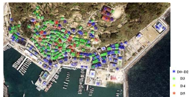
図-4 垂直航空写真の一棟単位での目視被害判読結果
