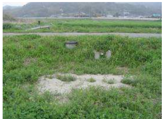
写真-10 志摩町野北の水田での噴砂跡
