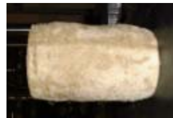
図2 圧縮試験後の供試体の様子
