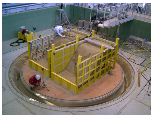
写真-1 模型盛土全景（製作過程）
