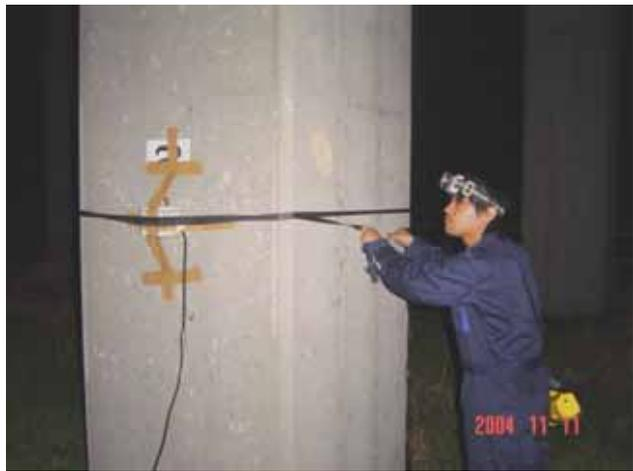
写真-1 橋脚にセンサーを設置する様子
