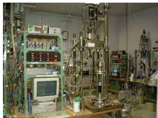
図-1 三軸圧縮繰返し試験装置全体写真
