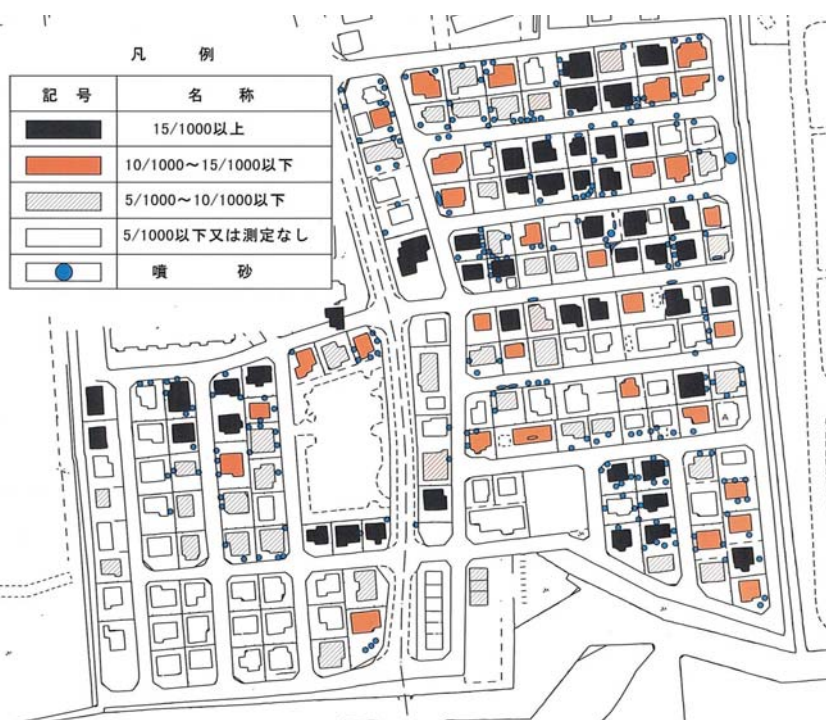
図-1 安倍彦名団地における液状化発生と家屋の傾斜状況 1)
