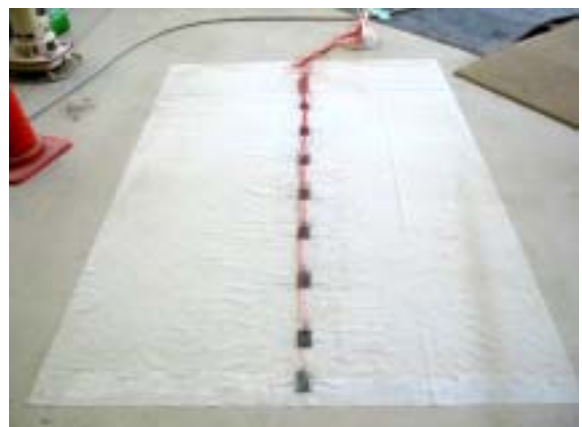
写真-6 遮水シート（実験後）
