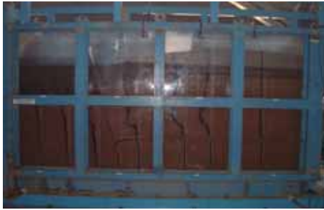
写真-2 剛体土槽による側方流動実験
