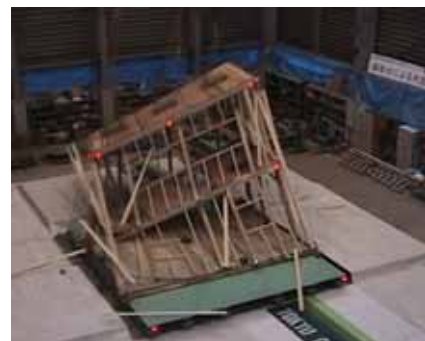
写真-4 木造住宅モデルの振動台倒壊実験
