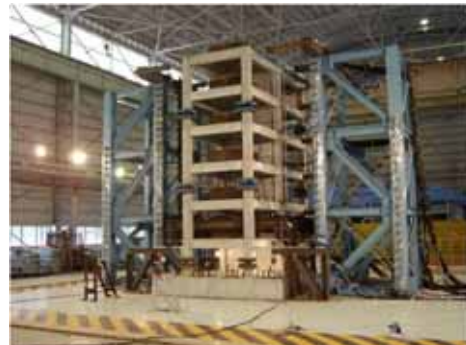
写真-1 耐震壁立体フレーム構造の振動台実験
