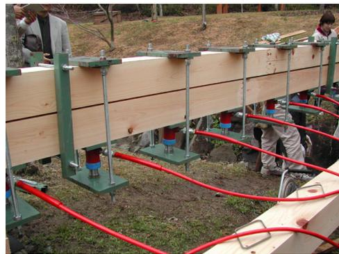
図-3 製作状況（油圧ジャッキによりジベルを圧入）
