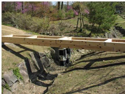
図-5 桁材完成時の試験対象構造物
