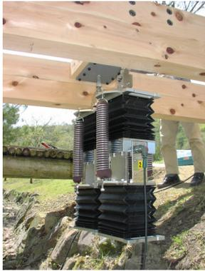
図-8 リニアモーター型加振機
