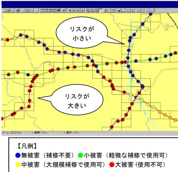
図-7 地震時被害評価結果の表示例
