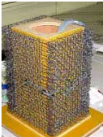
写真-1 配筋状況 (ボックスカルバート型試験体)
