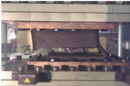
図-9 引張せん断試験における破断状況
