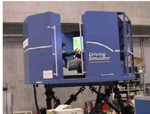
図-1 本研究で使用したドライビングシミュレータ
