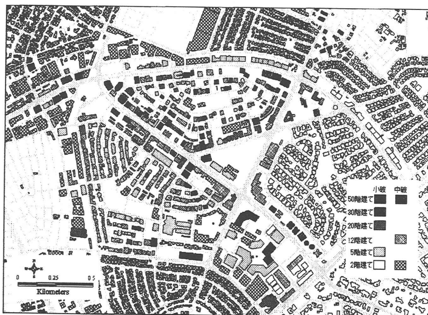
図-9 マカティ地区の建物被害
