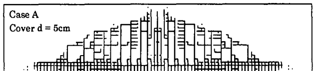
図-9 破壊したコンクリートバネの空間分布図 (鉄筋の降伏強度を変化させた場合、変位 = 1.5cm)
