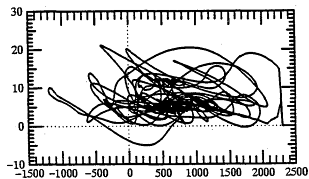
図-8 アーチリブ部材のM-N履歴曲線
