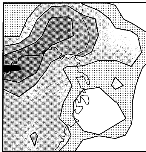
図-9 提案手法による補正を施した兵庫県南部地震の推定地震動分布
