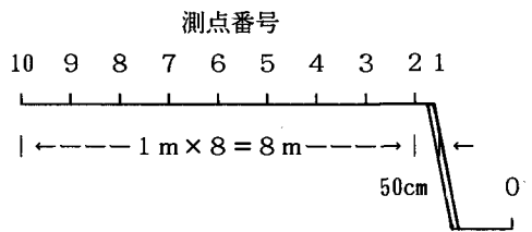
図-2 微動計の設置位置
