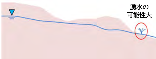
図-4 湧水可能性調査の模式図
