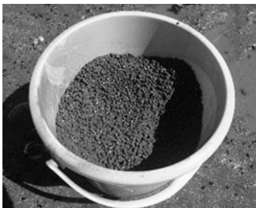
写真-2 新開発ペレット状フルボ酸鉄シリカ資材（構成している素材は従来品と同等）
