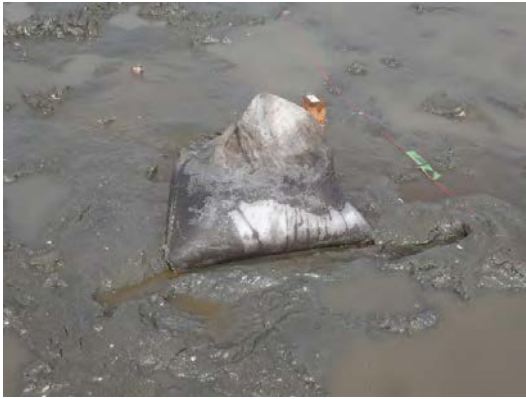
写真-1 従来型のフルボ酸鉄シリカ資材（外側の袋の素材は生分解性：おおよそ2年程度で分解される）
