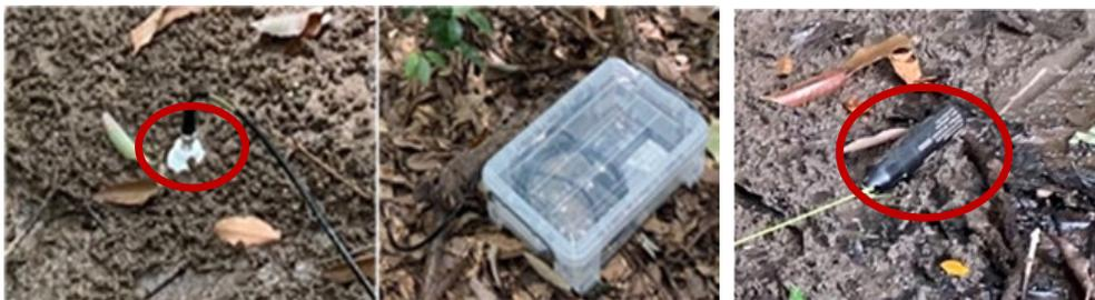
図 - 6 土中水分計 (左) と水位計 (右) 及びロガー (中央) の設置状況
