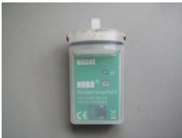
図-2 照度観測に用いた照度計 (onset 製 UA-002-64)
