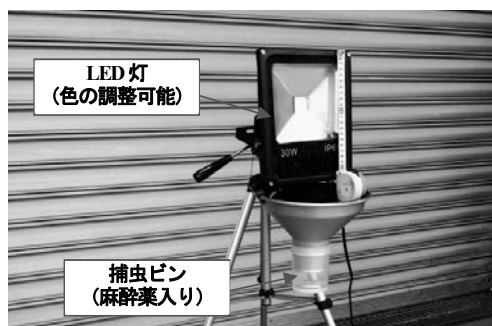
写真-1 LED灯の色を変更可能な試験装置
