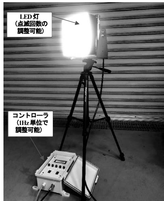
写真-5 点滅回数用の試験装置
